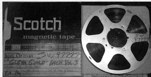
「平均律」第1巻第3集（第17番～第24番）のオリジナル・マスター。 1/2インチ幅・3トラックのマスターである（3M社製のスコッチ・ブランド）。
